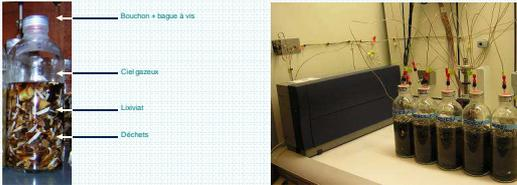
Réalisation de tests BMP (mesure du potentiel de production de méthane) de différents types de déchets apportés en ISDND.
