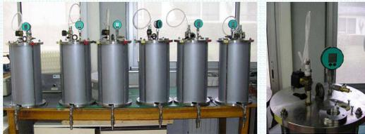
Réalisation d'essais en colonnes de laboratoire pour simuler l'effet de différentes stratégies de recirculation sur la production de biogaz.
