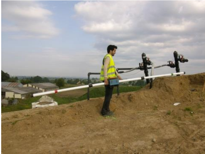
↑ Réalisation de mesure électromagnétique avec une EM31 lors d'une réinjection de lixiviat
